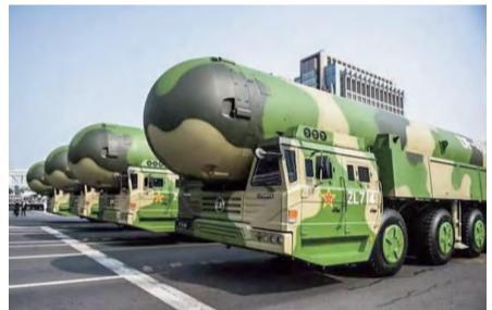
与东风一31AG相比,东风一41最直观的区别就是大,大到导弹将发射车驾驶室一分为二的程度。同为机动发射、固体燃料洲际导弹,东风一41的大块头决定了它比东风一31AG有更远的射程,更大的有效载荷,因此打击范围更广,摧毁能力更强,是名副其实的巨无霸。和东风一5B相比,同样是重型洲际导弹的东风一41,因为使用固体燃料作战反应速度更快,因为机动发射生存能力更强。此外,东风一41作为一款刚刚问世的洲际导弹,必然会大量运用最新的高科技特别是信息技术成果,因而在打击精度、突防能力等方面显著优于东风一31AG和东风一5B。在东风一41问世之前,我国现役两种型号洲际导弹——东风一31A/AG和东风一5B各有优长和不足。东风一31A/AG的优点在于生存能力和反应速度,但威力相对有限。而东风一5B作为重型洲际导弹,威力巨大,但井式发射和使用液体燃料决定了它的生存能力和快速反应能力要弱于东风一31A/AG。
